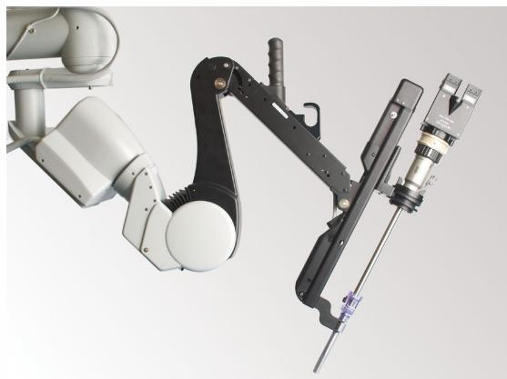
شکل (۷) بازوی نگهدارنده لاپاروسکوپ در سیستم جراحی Da Vinci
