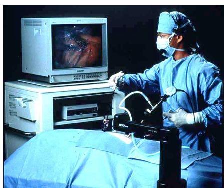
شکل (۱۱). ربات AESOP به عنوان نگهدارنده لپاروسکوپ در جراحی MIS
