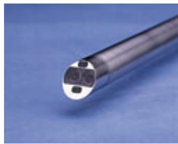
شکل (۸) اندوسکوپ به کار رفته در سیستم Da Vinci
